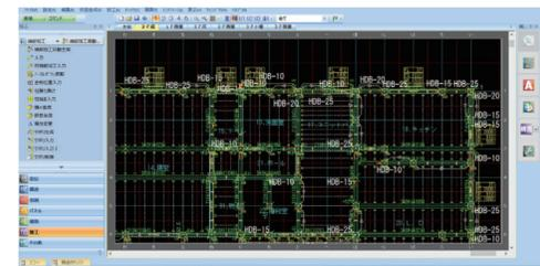
プレカットデータに基づいた、正確な構造計算をスムーズに行うことができ、(株)日本住宅・木材技術センターの「木造軸組工法の許容応力度設計（2017年版）」に準拠した構造計算書を作成することができます。「壁量・偏心率・N値計算」「金物工法対応」などのオプション商品もご用意しています。
